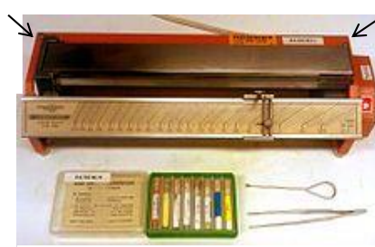
Banc Kofler: plaque chauffante dont la température croît progressivement vers la gauche
